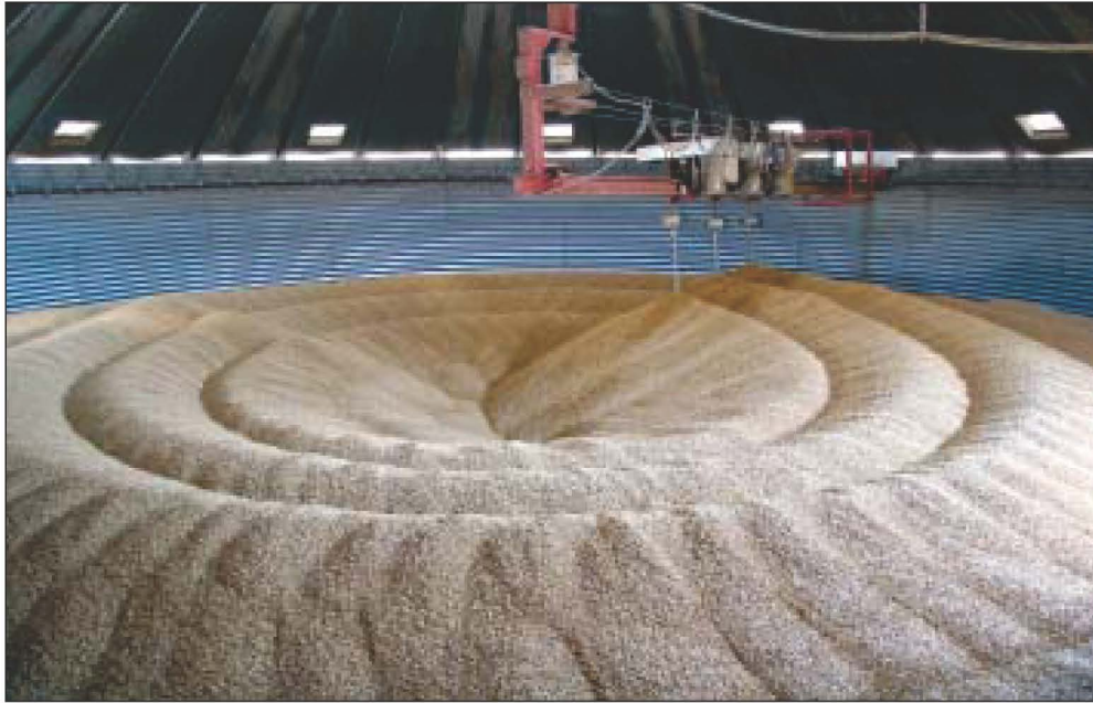
Omrøresneglene skal stikke helt ned til blot 10 centimeter over fejesneglen, og så skal de køre altid under fyldning, tømning og tørring. (Foto: Almas A/S)
